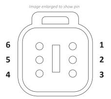
**6-** DIM OUT **1-** +12V IN **5-** GND **2-** GND IN **4-** IN2 **3-** IN1
